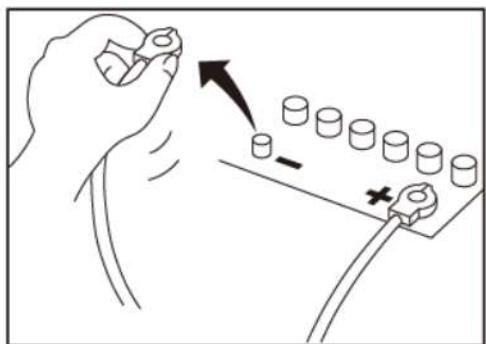
**Во избежание возможных коротких замыканий в электрической системе обязательно отключите (-) кабель аккумулятора перед установкой. Используйте это устройство только с 12-вольтовой батареей и отрицательным заземлением. Несоблюдение этого может привести к возгоранию или неисправности.**
