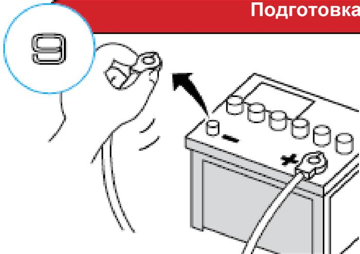
Чтобы избежать короткого замыкания, отсоедините все провода от минусовой клеммы аккумулятора перед установкой. Используйте устройства только с аккумулятором на 12 вольт и минусовым заземлением. В противном случае возможны поломки и возгорания.
